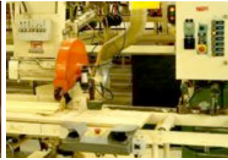
Parallellkapsåg med maskinell matning av sågklingan
