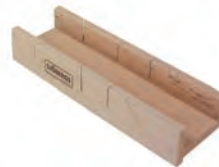
SÅGLÅDA Såglåda för kapning av lister i 45 och 9°. 445 x 135 x 70 mm. Max sågbredd: 100 mm Max såghöjd: 50 mm Art nr S-33710 Ingår inte i verktygspaketet
