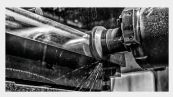
Edge milling of cast iron table
